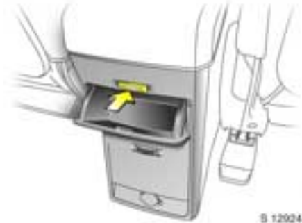
Compartimentul de depozitare ✱ Amplasat în spatele consolei centrale. Deschiderea: apăsați butonul aflat deasupra compartimentului de depozitare.
