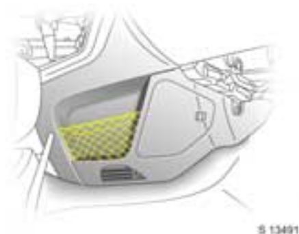
Plasa de protecție a consolei ✱ Localizată în zona pentru picioare a pasagerului din față.
